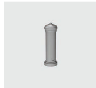
BOLLARD MBO-0200 TUBE EN ACIER RAPIDE, DESSUS ET BASE EN ALUMINIUM MOULÉ INSTALLATION: ENFOUSSEMENT DIRECT, AMOVIBLE
